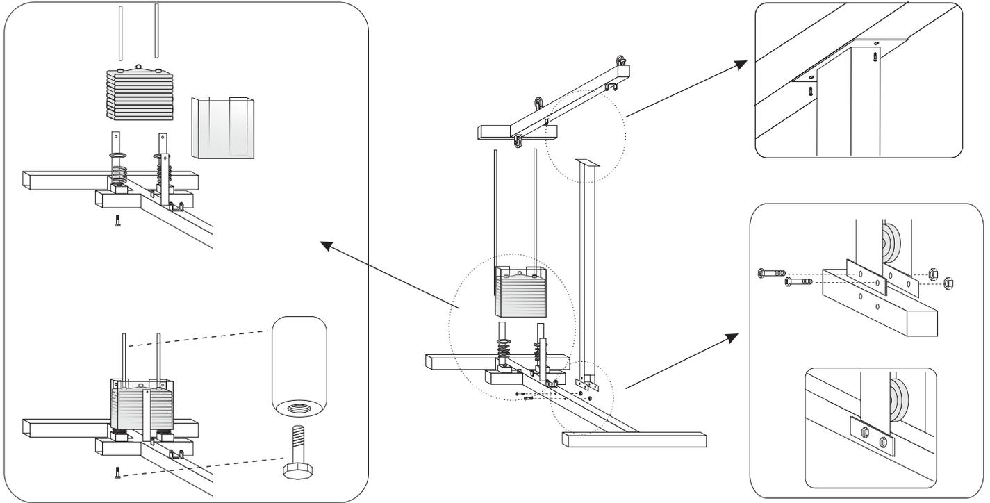
Inicie a montagem pelos tijolos (17), hastes (18), protetor (16), conectando-os entre a base inferior (1) e a base superior (20) juntamente com a coluna (11)
